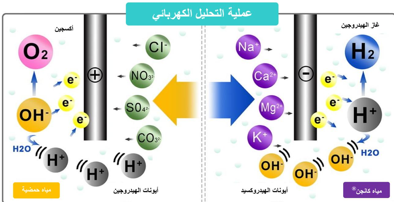
**الخطوة 2: التحليل الكهربائي:** - يتم فصل المياه المرشحة إلى جزيئات حمضية وقلوية من خلال عدة صفائح وأغشية للأقطاب الكهربائية مصنوعة من التيتانيوم المطلي بالبلاتين. تتفصل على إثرها المياه إلى OH- (أيونات الهيدروكسيد) و H+ (أيونات الهيدروجين).
